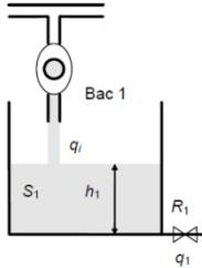
On considère le système ci-dessus. Le débit  $q_1$  de la vanne est linéaire et supposé proportionnel à la hauteur de liquide  $q_1 = \frac{h_1}{R_1}$ . La surface du bac est notée  $S_1$ . Le bac est alimenté par un débit  $q_i(t)$ . (conditions initiales nulles)
