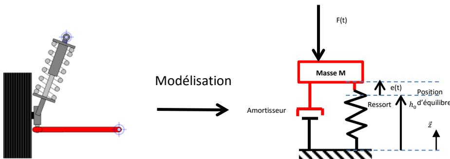
On considère le modèle d'un véhicule de masse  $M=1$  tonne dont on étudie la variation de l'altitude autour de sa position d'équilibre repérée par  $e(t)$  lorsqu'on lui applique un effort noté  $F(t)$ . Le véhicule est équipé de suspension de type Mac Pherson modélisable pour chacune des roues par deux éléments en parallèle : un ressort de raideur  $\frac{k}{4} = 25$  N/mm et un amortisseur visqueux de coefficient  $\frac{b}{4} = \frac{25}{4}$  N/(mm/s).
