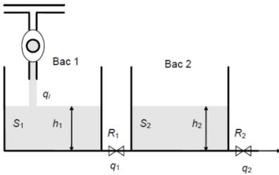
On considère le système ci-dessus. Le débit de chaque vanne est linéaire et supposé proportionnel à la hauteur de liquide  $q = \frac{h}{R}$ . Les surfaces de chaque bac sont notées respectivement  $S_1$  et  $S_2$ . Le bac 1 est alimenté par un débit  $q_i(t)$ .
