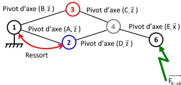
**Q2.** Faire le bilan des actions mécaniques obtenues lorsque l'on isole 3.
