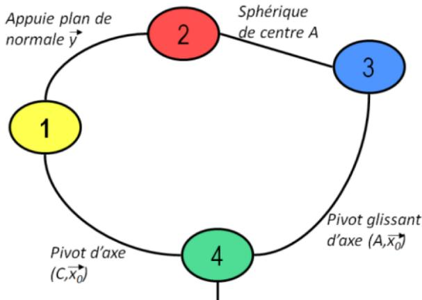
**Question 2.** Ecrire le torseur cinématique et le torseur des actions mécaniques transmissibles de la liaison entre 1 et 2 au point B.
