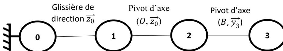
**Question 2.** Ecrire le torseur cinématique et le torseur des actions mécaniques transmissibles de la liaison entre 0 et 1 au point O.
