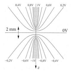
Ce logiciel donne aussi le graphe des variations du potentiel V en fonction de z sur l'axe :
