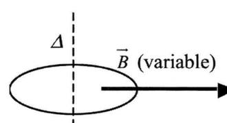
Cas 2 : la spire est immobile dans un champ magnétique uniforme orthogonal à son axe, d'amplitude  $0,1 \text{ T}$  et de fréquence  $50 \text{ Hz}$ .
