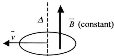
Cas 4 : la spire se déplace sans changer d'orientation avec une vitesse  $2 \text{ m} \cdot \text{s}^{-1}$  orthogonale à son axe dans un champ magnétique constant et uniforme de  $0,1 \text{ T}$ .
