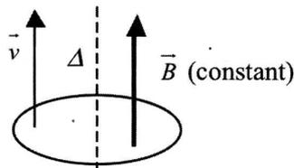
Cas 3 : la spire se déplace sans changer d'orientation avec une vitesse de  $2 \text{ m} \cdot \text{s}^{-1}$  parallèle à son axe dans un champ magnétique constant et uniforme de  $0,1 \text{ T}$ .
