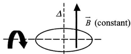
Cas 6 : la spire tourne avec une vitesse angulaire de  $5 \text{ rad} \cdot \text{s}^{-1}$  autour d'un de ses diamètres dans un champ magnétique constant et uniforme parallèle à son axe de  $0,1 \text{ T}$ .
