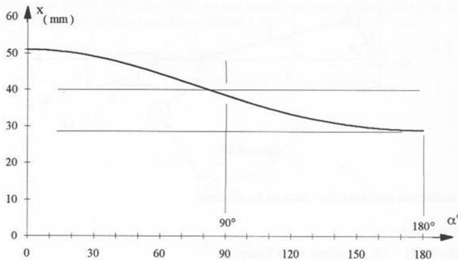
La cylindrée d'un moteur ou compresseur correspond au volume balayé par le piston lorsqu'il passe de la position « point mort bas » (position extrême basse) au « point mort haut » (position extrême haute). Si le mécanisme possède plusieurs cylindres, il faut multiplier ce volume par le nombre de cylindres.
