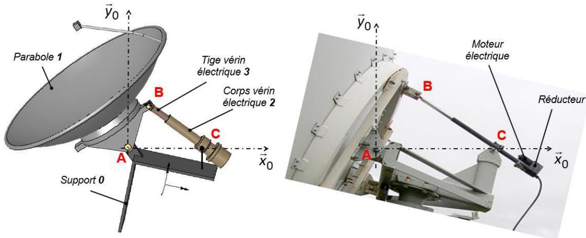
Le dispositif d'orientation ci-dessus est appelé « 3 barres » :
