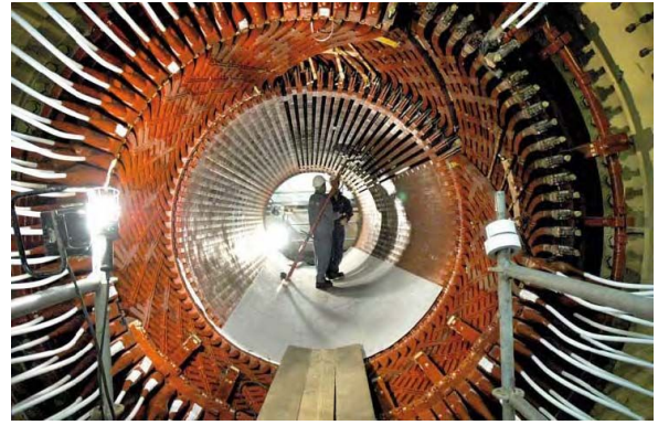
(b) Stator d'un alternateur de centrale nucléaire
