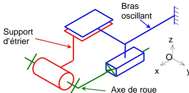
Schéma cinématique en phase de réglage de la tension de la chaîne
