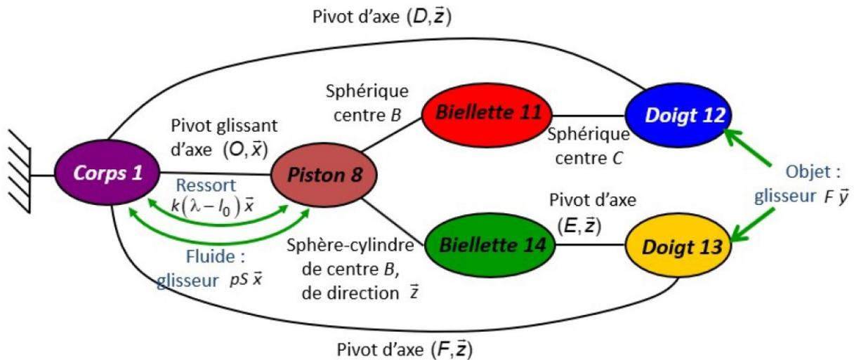
**Question 3.** Ecrire les torseurs représentant les actions mécaniques du ressort et du fluide mis sous pression sur le piston 8.
