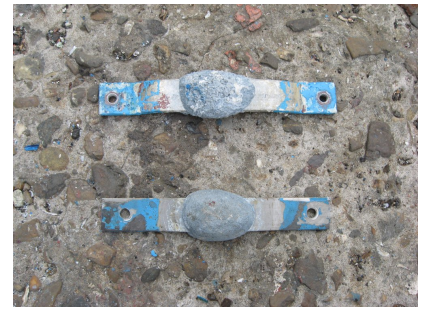
(c) Anodes sacrificielles usées.
