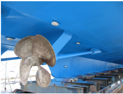
(a) Anodes sacrificielles en places.
