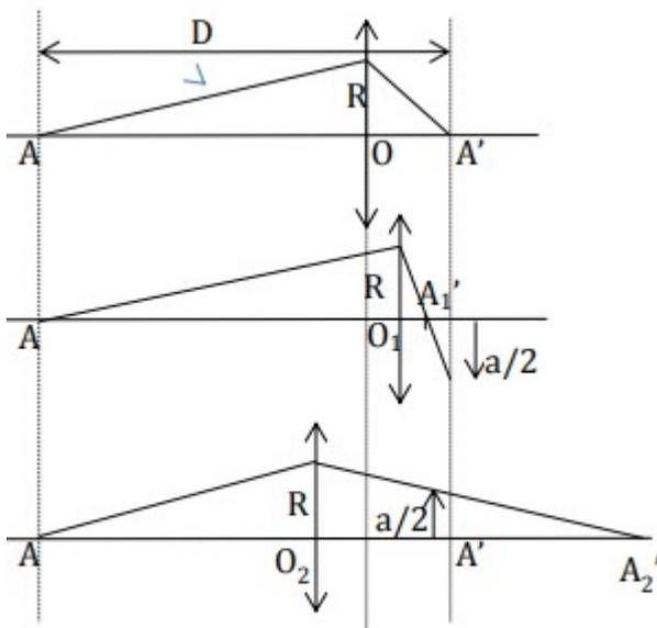
On cherche la distance  $O_2O_1$  telle que l'image du point A soit toujours inférieure à a. Pour cela on trace le rayon issu de A passant par l'extrémité de la lentille de rayon R.
