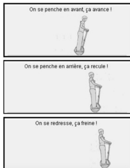
Figure 7 : principe de fonctionnement du segway
