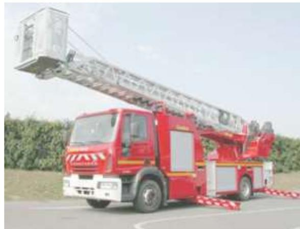
**Figure 1 :** Echelle Pivotante Automatique à commande Séquentielle sur un camion
