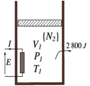
AN :  $\theta_2 = \frac{8,314 \times 300,15}{400 \cdot 10^3 \times 0,5 \times 28 \cdot 10^{-3} \times 1039} (120 \times 2 \times 5 \times 60 - 2800) + 27 = 56,7 \approx 57^\circ \text{C}$
